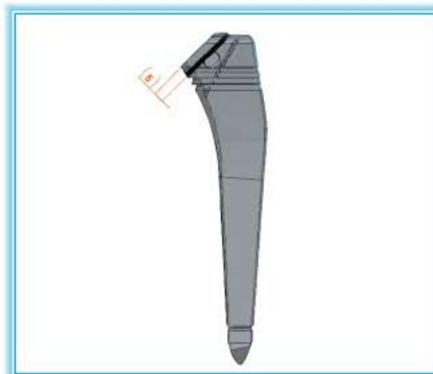
Las raspas de tallas crecientes se introducen hasta la obtención de un bloqueo completo, la primera raspas determina la posición de las demás raspas.
